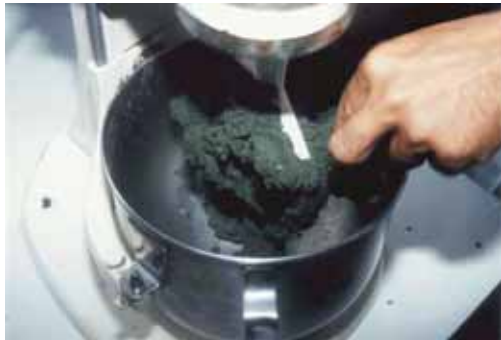
ภาพที่ 9 และ 10 ผสมสารอาหารให้เข้ากันดี แล้วบดอาหารโดยใช้เครื่องบดเป็นเส้น เพื่อให้อาหารละเอียดและผสมเข้ากันดีอีกครั้ง
