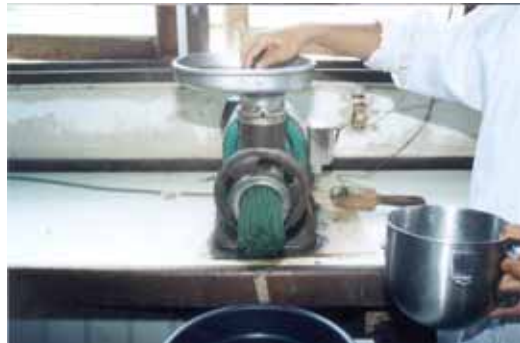
ภาพที่ 9 และ 10 ผสมสารอาหารให้เข้ากันดี แล้วบดอาหารโดยใช้เครื่องบดเป็นเส้น เพื่อให้อาหารละเอียดและผสมเข้ากันดีอีกครั้ง
