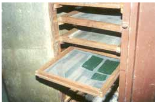
ภาพที่ 13 และ 14 อาหารที่ตัดแล้วนำเข้าตู้อบที่อุณหภูมิ 55-60 องศาเซลเซียส นาน 4 ชั่วโมง หรือจนกระทั่งมี ความชื้นไม่เกิน 10 %
